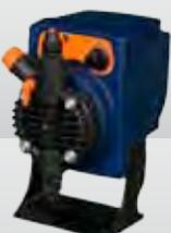
Pompa dosatrice con dosaggio proporzionale ad un segnale remoto in ingresso libero da tensione (es. da contatore lanciainpulsi). La proporzionalità può essere del tipo 1:1 (F) o a tempo (T), regolabile tramite manopola da 0 a 60 secondi. Un pulsante seleziona la modalità F o T. Predisposizione per la sonda di livello (sonda di livello esclusa). Disponibile con cavo di alimentazione a connettore estraibile.
